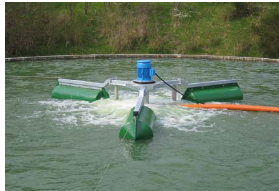
Centrox-Begaser auf Schwimmer im Prüfbecken
